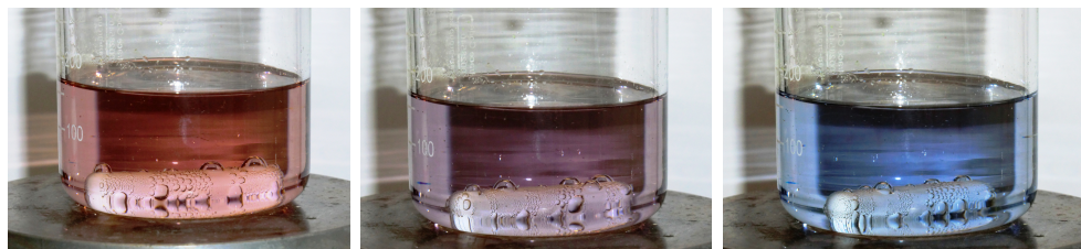
Abbildung 9: Abnahme der Konzentration an Ferroin von links nach rechts (eigenes Experiment)
