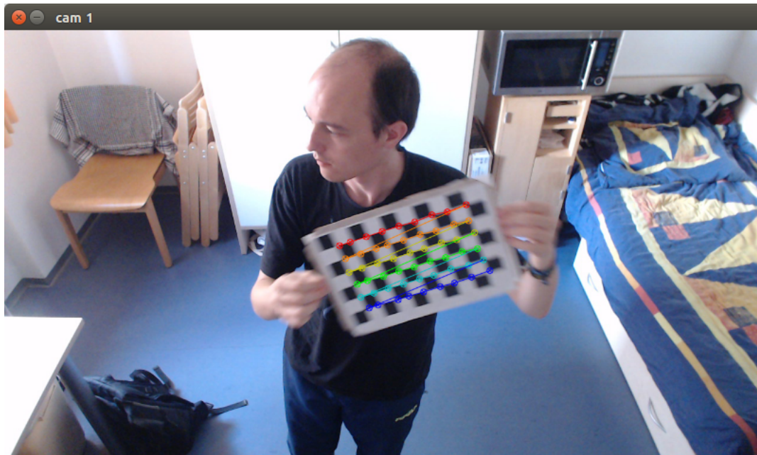
Abbildung A.3: Das Schachbrettmuster wurde hier zwar erkannt, aber manche Eckpunkte konnten nicht gut bestimmt werden. Diese Aufnahme sollte nicht zum Kalibrieren verwendet werden.
