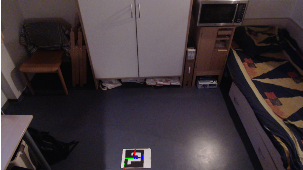
Abbildung A.5: Wenn der AR-Marker erkannt wird, wird dessen Orientierung durch ein eingezeichnetes Koordinatensystem dargestellt.
